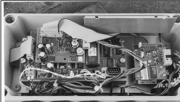
Vue intérieure d'un coffret de poste avec notamment le modem et la carte microcontrôleur.
