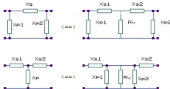
On réalise, en fait, coté source et coté charge, une adaptation à  $R_v$  avec de chaque coté un circuit en L d'où la possibilité, en choisissant  $R_v$ , de choisir un  $Q$  d'un coté (en général coté charge)
