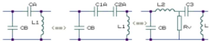
$$\omega = 2\pi \cdot 21,410^6 \quad C_B \text{ et } C_{1A} \text{ même nature donc problème} \rightarrow jL_2\omega - \frac{j}{C_3\omega} = -\frac{j}{C_A\omega} \quad (1)$$
