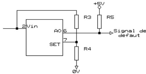
$R_5$  = résistance de tirage  $100k\Omega$   $\frac{1}{4}W$ ,  $R_3$  et  $R_4$  telles que  $V_{in} = V_{REF} \frac{R_3 + R_4}{R_4}$
