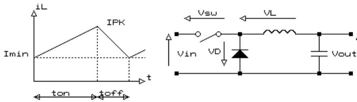
a) diode bloquée ( $t_{on}$ )  $v_L = V_{in} - V_{sw} - V_{out}$
